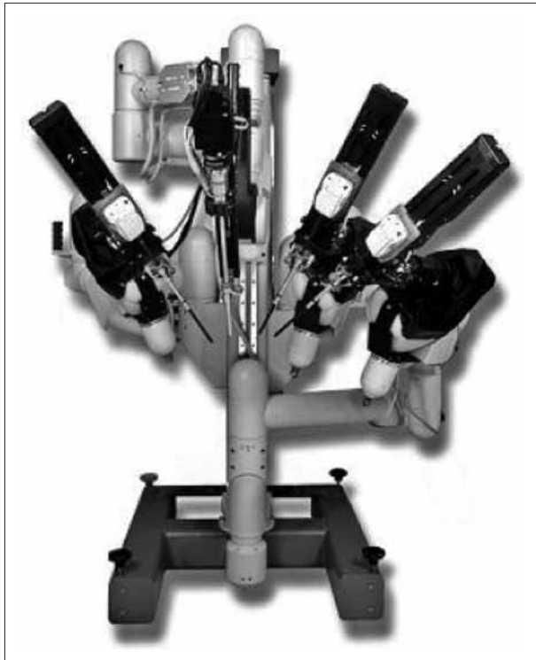
Figura 3. Robot (Da Vinci) de 4 brazos.
