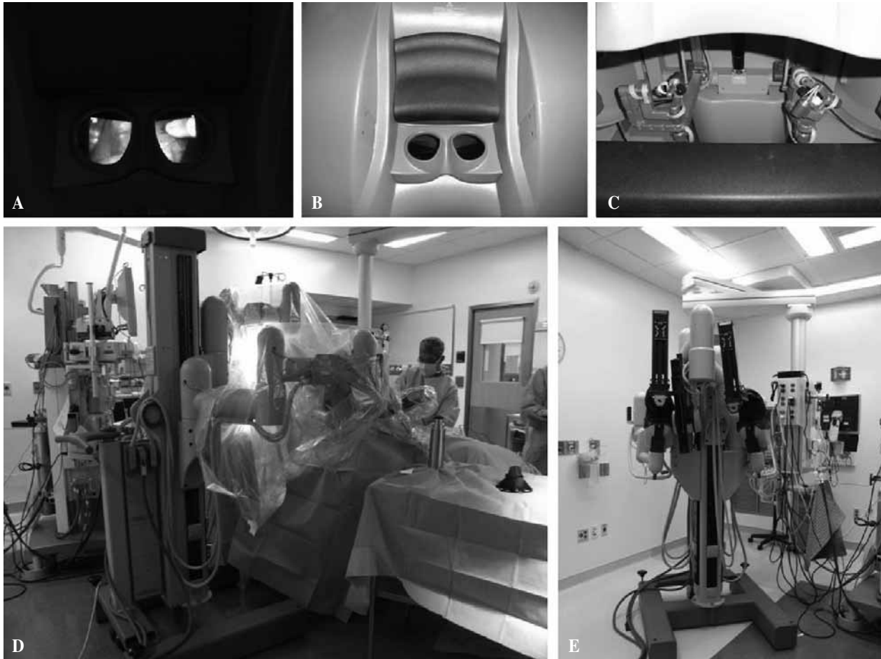
Figura 1. A) Visión tridimensional. B) Sitio de la consola donde se coloca la cabeza del cirujano para accionar los controles de la consola. C) Controles de la consola cuyos movimientos reproducen los brazos del robot. D) Robot ensamblado. E) Robot de 3 brazos.
